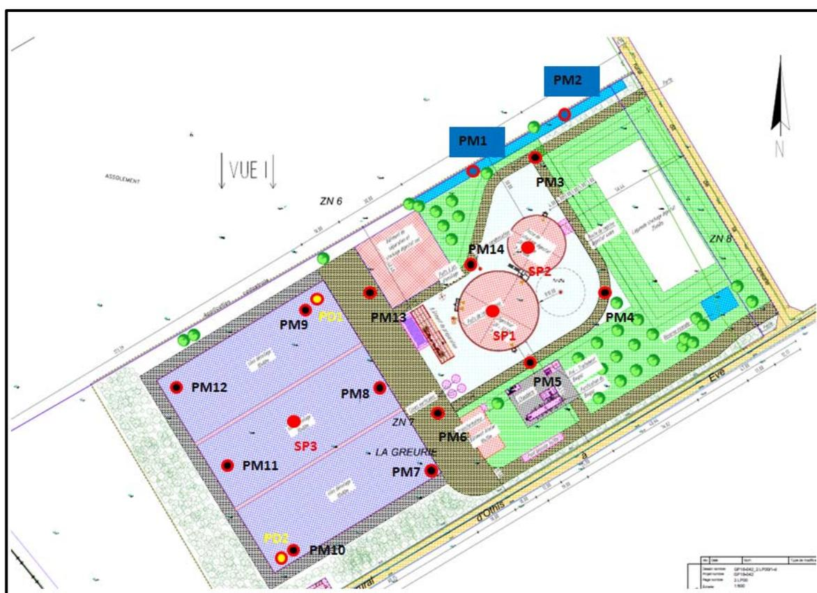
**Figure 5 : Plan des Installations et sondages réalisés**
